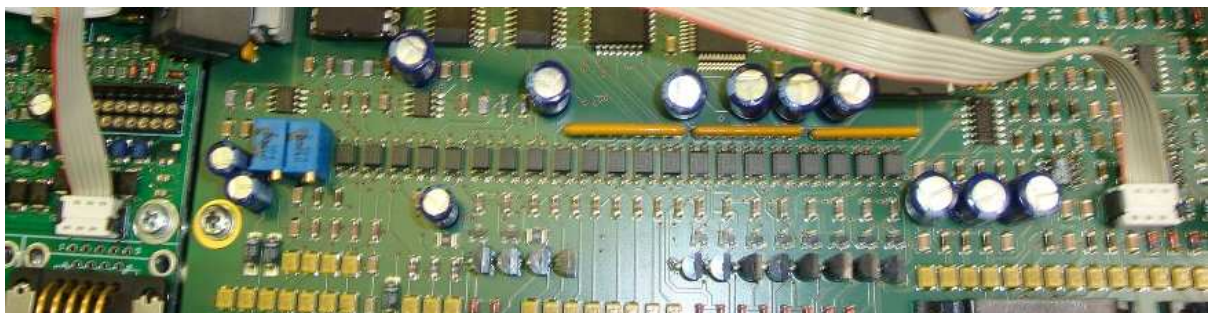
Neue Anschlusstechnik über beidseitige MIC-Verbinder (gleicher Kabel-Typ, wie für Option X6 und X7)
